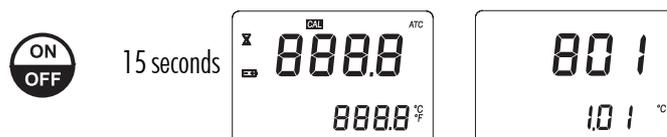
2. Mientras sigue manteniendo pulsada la tecla **ON/OFF**, pulse la tecla **ZERO**. La unidad de temperatura cambiará de °C a °F o viceversa.
