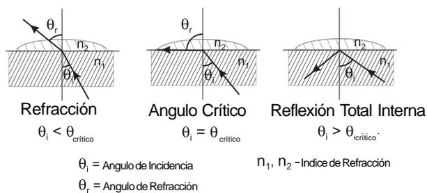
En el HI 96801, la luz procedente de un LED pasa a través de un prisma en contacto con la muestra. Un sensor de imagen determina el ángulo crítico al que la luz ya no refracta a través de la muestra. El HI 96801 aplica automáticamente la compensación de temperatura y convierte el índice de refracción de la muestra a concentración de sacarosa en unidades de porcentaje (por peso) Brix.
