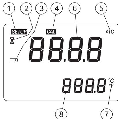
1. SETUP: Indicador de Calibración de Fábrica
