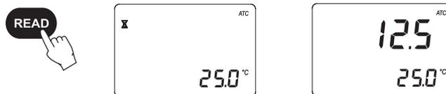
**Nota:** El indicador **ATC** parpadea y la compensación automática de temperatura se inhabilita si la temperatura sobrepasa el rango de 10-40°C / 50-104°F.
