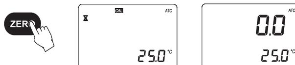
4. Absorba suavemente el estándar de agua ZERO con papel absorbente suave. Tenga cuidado de no rayar la superficie del prisma. Limpie la superficie completamente. El instrumento está listo para medir la muestra. **Nota:** Si el instrumento se desconecta no se perderá la calibración.
